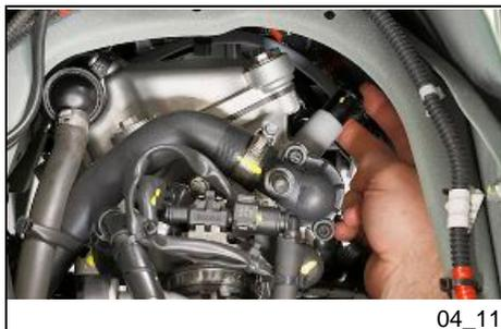
Die Zündkerzenkappe durch Lösen des Hochspannungskabels aus dem Sicherungsbügel und Drehen im Uhrzeigersinn abstecken.
