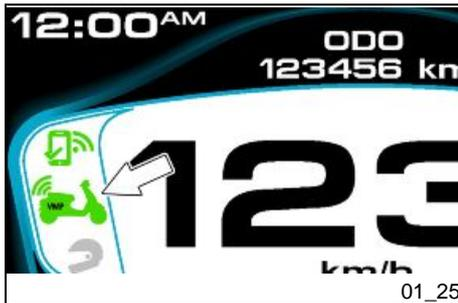
Unter den oben beschriebenen Bedingungen ist es durch Aktivieren der zuvor auf dem Smartphone installierten entsprechenden VMP-Applikation möglich, auf Informationen zum Fahrzeug und zur Fahrt zuzugreifen; das entsprechende Symbol im Display leuchtet grün auf.
