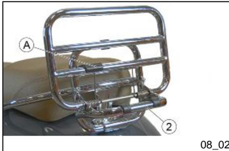
Das Fahrzeug ist (sofern vorhanden) mit dem auf dem Foto gezeigten hinteren Gepäckträger "2" ausgestattet.
