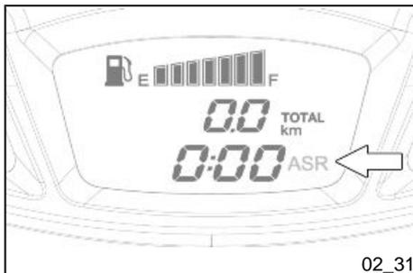
9. Wenn das Verfahren **NICHT korrekt abgeschlossen wurde**, schaltet sich das **«ASR»-Symbol aus**, um anzuzeigen, dass das **ASR-System DEAKTIVIERT ist**. Durch Drücken der vorgesehenen Taste kann der Benutzer das ASR-System manuell wieder aktivieren und auf die zuvor gespeicherte Kalibrierung zurücksetzen oder eine neue manuelle Kalibrierung vornehmen, indem er das Verfahren von Anfang an wiederholt.
