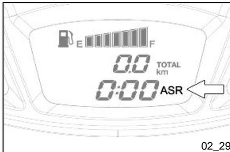
6. Losfahren und **innerhalb von 25 Sekunden eine Geschwindigkeit von 30 km/h erreichen, die Geschwindigkeit mindestens 10 Sekunden lang konstant beibehalten,**
