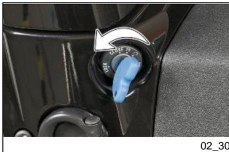
7. Das Fahrzeug anhalten und **den Motor abschalten**, indem man den Schlüssel auf OFF dreht..
