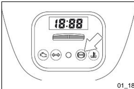
Bei jedem Schalten des Schlüssels auf «ON», führt die ABS-Steuereinheit eine Kontrolle des Systems durch, während der die ABS-Kontrolllampe blinkt. Diese Phase endet bei Überschreiten der 5 Km/h Geschwindigkeit mit Ausschalten der Kontrolllampe.
