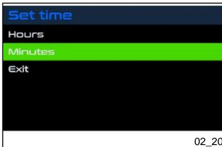
Die Funktion «**Minuten**» (**Minutes**) markieren. Durch kurzen mittleren Druck des Joysticks in das Menü gehen.
