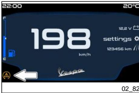
9. Wenn das Verfahren **NICHT korrekt abgeschlossen wurde, zeigt das fest leuchtende Symbol «ASR» an, dass das ASR-System DEAKTIVIERT ist.** Durch Drücken der vorgesehenen Taste kann der Benutzer das ASR-System manuell wieder aktivieren und auf die zuvor gespeicherte Kalibrierung zurücksetzen oder eine neue manuelle Kalibrierung vornehmen, indem er das Verfahren von Anfang an wiederholt.
