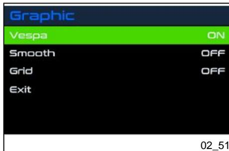
Man kann unter verschiedenen Hintergrundgrafiken für das Digitaldisplay wählen. Den Joystick kurz nach oben oder unten drücken, um die gewünschte Option zu markieren. Durch den kurzen mittleren Druck des Joysticks die gewählte Option bestätigen. Die Wahl schließt die anderen aus.
