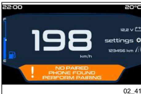
Alle gespeicherten Bluetooth-Geräte werden vom System «**Vespa MIA**» gelöscht. Auf dem Digitaldisplay erscheint die Bestätigungsmeldung der erfolgten Löschung. Man kann den Vorgang zum Koppeln eines neuen Smartphones wiederholen.
