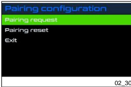
Die Funktion «**Kopplungsanforderung**» (**Pairing request**) markieren und kurz die mittlere Taste des Joysticks drücken.
