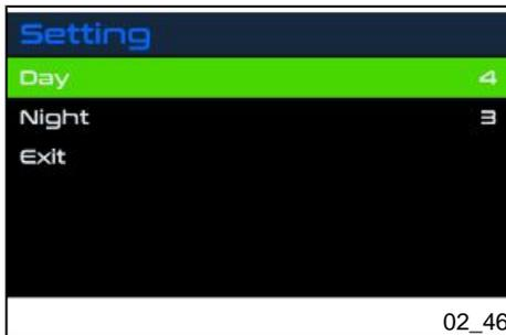
Die Funktion «**Tag**» (**Day**) markieren. Durch kurzen mittleren Druck des Joysticks in das Menü gehen.
