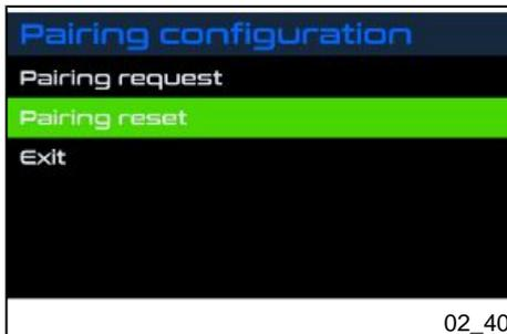
Falls es notwendig sein sollte, das Smartphone zu entkoppeln, wie folgt vorgehen. Die Funktion «**Reset Kopplung**» (**Pairing reset**) markieren und kurz die mittlere Taste des Joysticks drücken.
