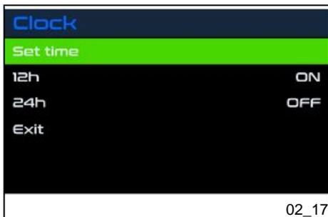
Die Funktion «Uhrzeit einstellen» (**Set time**) markieren und durch kurzen mittleren Druck des Joysticks in das Menü gehen.
