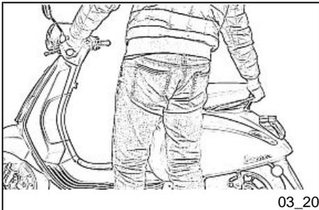
**8.** Das Fahrzeug mit ausgeschaltetem Motor bewegen, indem man es mit einer Hand am Lenker und mit der anderen am hinteren Griff festhält.
