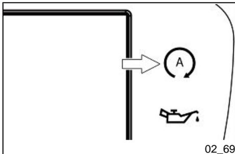
Wenn die "Start&Stop"-Funktion aktiviert ist, leuchtet die entsprechende Kontrolllampe auf der Instrumententafel auf.
