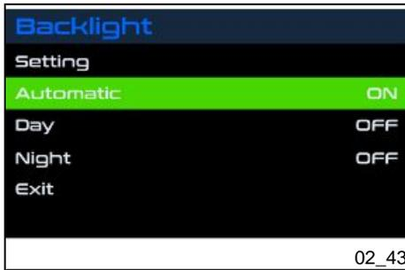
Den Joystick kurz nach oben oder unten drücken, um die gewünschte Option zu markieren. Durch den kurzen mittleren Druck des Joysticks die gewählte Option bestätigen. Die Wahl schließt die anderen aus.
