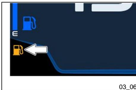
Das Einschalten der speziellen Kontrolllampe auf dem Digitaldisplay, zusammen mit der Anzeige in roter Farbe der seitlichen Leiste zeigt an, dass die Benzinreserve erreicht wurde, so schnell wie möglich tanken.
