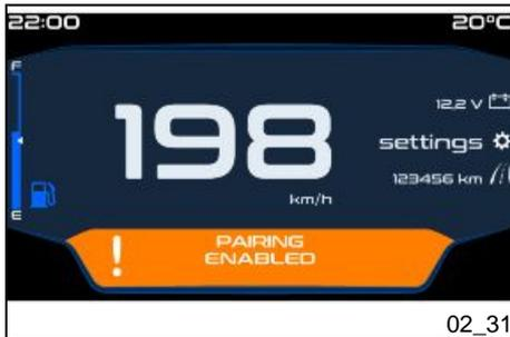
Auf dem Digitaldisplay erscheint die Meldung, die die Freigabe zur Kopplung mit dem Smartphone bestätigt. Die Bluetooth-Suche auf dem eigenen Smartphone aktivieren, das Gerät «**BT-ROUTER**» wählen, falls gefordert, das Passwort "0000" eingeben und auf verbinden drücken.
