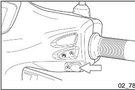
3. **Das ASR-System deaktivieren**, indem der Anlasserschalter mindestens 4 Sekunden lang mit laufendem Motor gedrückt wird. **Das Symbol «ASR» beginnt, fest zu leuchten**. Anfänglich war es ausgeschaltet, da das ASR-System bereits zuvor kalibriert worden war.
