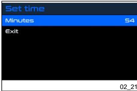
Den Joystick kurz nach oben oder unten drücken, um die richtigen Minuten einzustellen. Den Joystick kurz in der Mitte drücken, um die Wahl zur bestätigen. Die grüne Leiste bestätigt die Auswahl.
