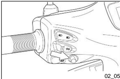
Der Joystick **MODE** ermöglicht die zyklische Anzeige der an der Multifunktionstafel des Digitaldisplays sichtbaren Informationen. Außerdem ist mit ihm die Navigation im Menü «**Settings**» und die Einstellung der verschiedenen Parameter möglich.
