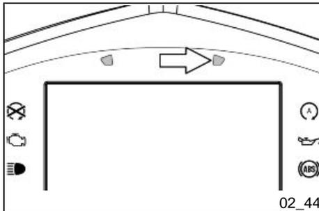
Die Option «Automatisch» (**Automatic**) ermöglicht den automatischen Übergang von der Tages- zur Nacht-Grafik je nach dem vom Helligkeitssensor auf dem Armaturenbrett erfassten Licht.
