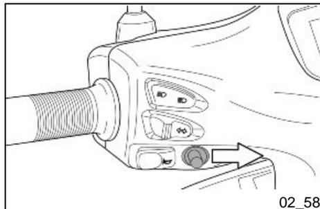
Durch langen Druck des Joysticks MODE nach RECHTS gelangt man zur Seite der GPS-Angaben.
