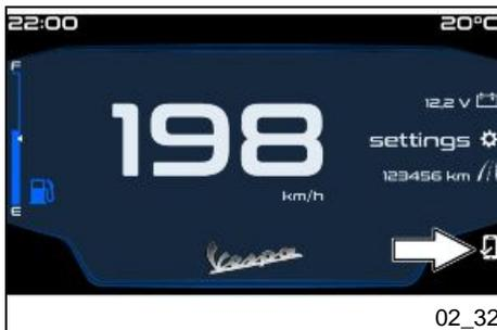
Auf dem Smartphone ist das Gerät «**BT-ROUTER**» in der Liste der gekoppelten Geräte sichtbar. Warten bis das Digitaldisplay das Smartphone automatisch verbindet. **Die Verbindung NICHT über das Telefon erzwingen.** Das Smartphone-Symbol am Display meldet die aktive Kommunikation. **Der gemeinsamen Nutzung von Adressbuch und Benachrichtigungen zustimmen, wenn verlangt. Dies ist notwendig, um den Namen des Anrufers am Display und die Benachrichtigungen über eingegangene SMS anzuzeigen.**
