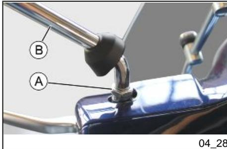
Zum Ausbau des Rückspiegels den Gummischutz anheben, die Kontermutter «A» leicht losschrauben, um den Schaft zu lösen. Den Schaft «B» soweit abschrauben, bis er abgenommen werden kann.
