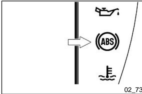
Bei jedem Schalten des Schlüssels auf «ON», führt die ABS-Steuergerät eine Kontrolle des Systems durch, während der die ABS-Kontrolllampe blinkt. Diese Phase endet bei Überschreiten der 5 Km/h Geschwindigkeit mit Ausschalten der Kontrolllampe.
