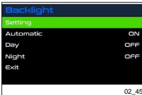
Die Funktion «Einstellung» (**Setting**) markieren. Durch kurzen mittleren Druck des Joysticks in das Menü gehen.
